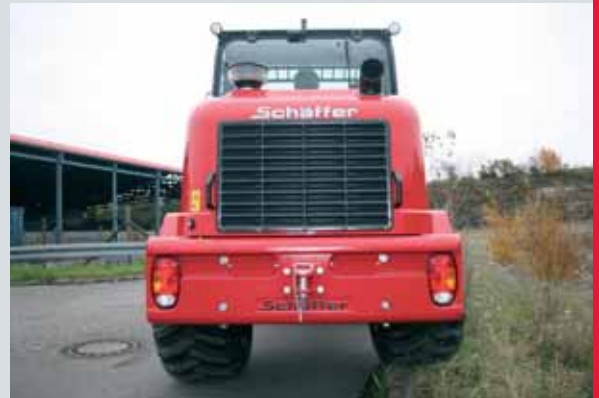
Die hintere Achse ist pendelnd aufgehängt für mehr Stabilität und höhere Schürfkraft.
