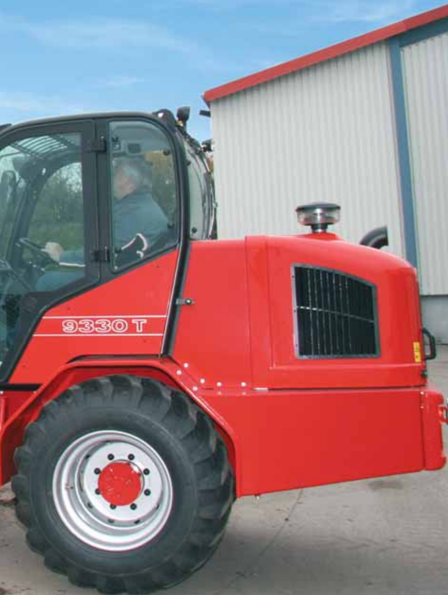
Die hintere Achse ist pendelnd aufgehängt für mehr Stabilität und höhere Schürfkraft.
