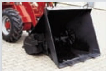
Futterdosiergerät mit Schnecke für Kraft- und Quetschfutter
