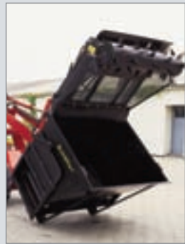
Futterdosiergerät mit aufgebauter Turbo-Fräse
