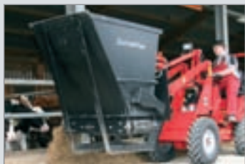
Futterdosiergerät mit Gummilaufband
