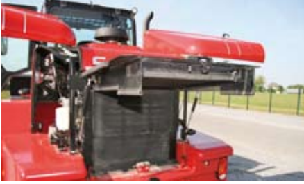
Nach dem Hochklappen des Kühlers für die Klimaanlage ist der Hauptkühler zugänglich.
